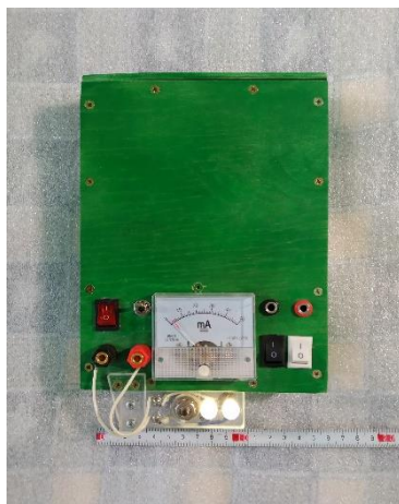
Рис. 6. Энергоблок на 6 В с двумя светодиодами
