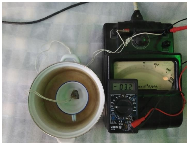
Рис. 4. Измерение напряжения и тока с обкладок пирамидального конденсатора, размещённого в стальной кастрюле
