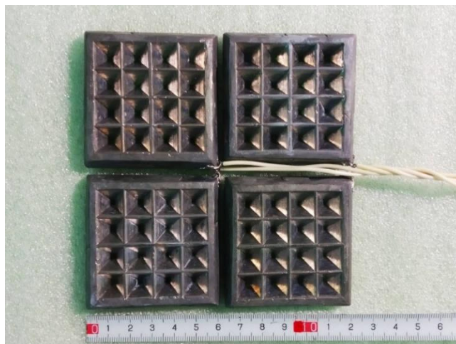
Рис. 2. Цельнометаллические матрицы с пирамидальными полыми ячейками
