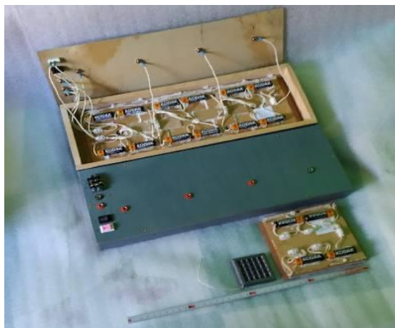
Рис. 7. Энергоблок на 18 В и его элементы
